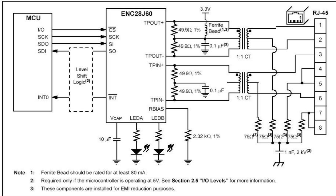
注：网络变压器可以用裕泰电子公司的 YL18-2050S, TX 1CT: 1CT
